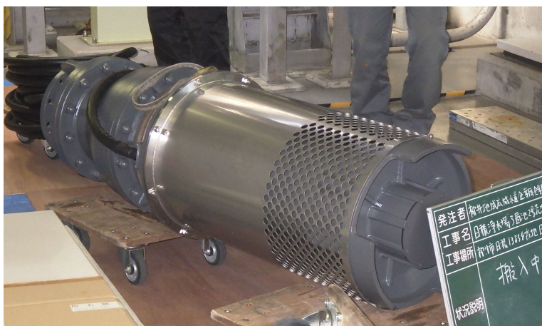
写真 6 日積浄水場ろ過池表洗ポンプの修繕
